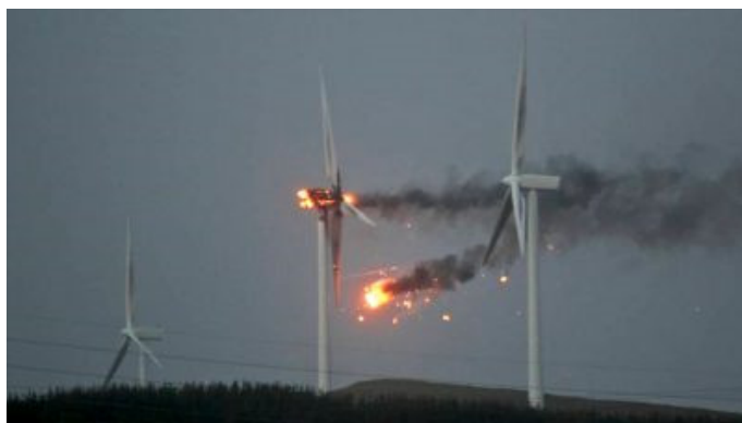
Une éolienne frappée et détruite par la foudre à Ardrossan, Écosse, le 8 décembre 2011.
